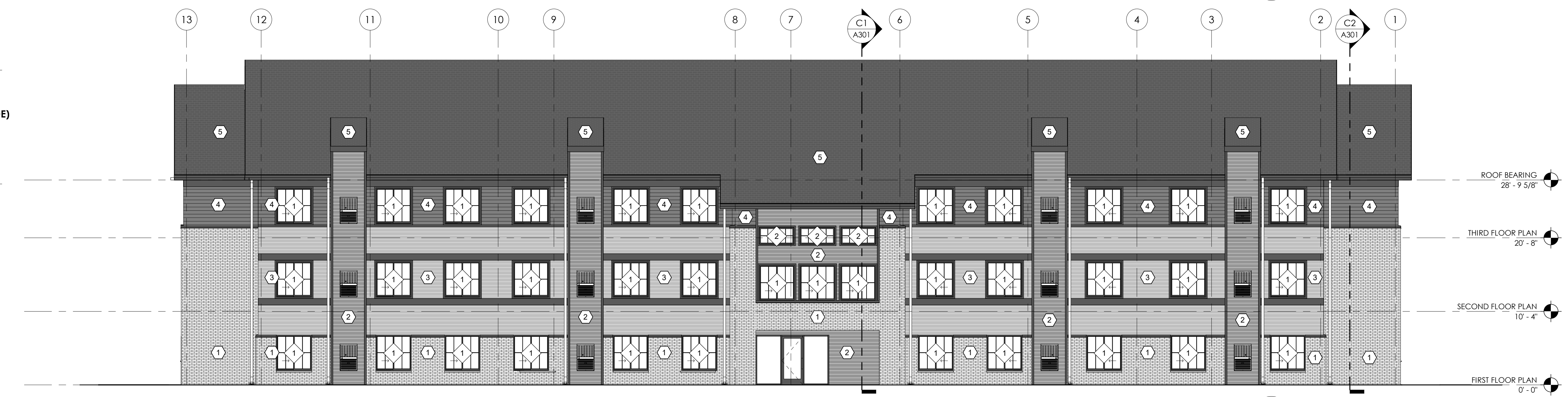
A1 SOUTH ELEVATION SCALE: 1/8" = 1'-0"
